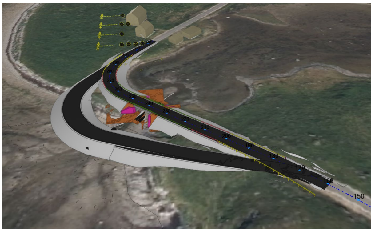
Figur 4. Illustrasjon av ny bru og midlertidig bru (fylling i sjø på vestsiden av eksisterende).
